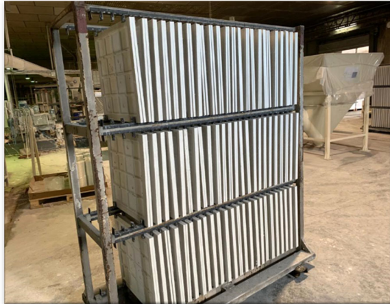
IMAGEN 5. FABRICACIÓN DE PLACAS DE YESO CON POLIURETANO
